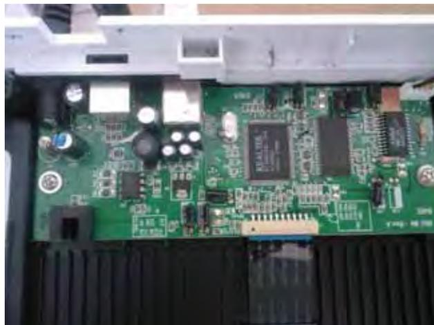
Figura 3.8 - Placa de circuito com a interface USB do digitalizador.
