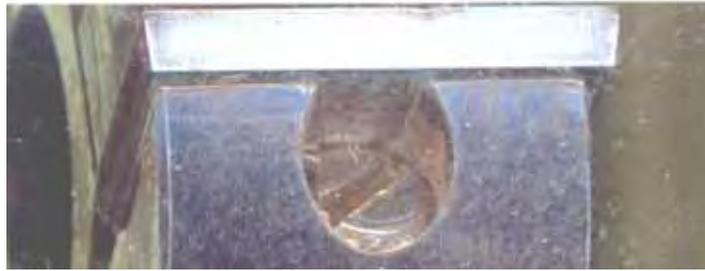
Figura 4.10 – Ferramenta de corte posicionada no digitalizador de mesa para registro da imagem do desgaste.
