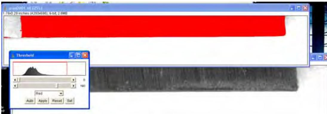
Figura 4.27 - Aplicação do comando de limiarização denominado “Threshold”.
