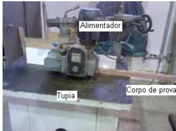
Figura 4.13 – Vista geral do banco de ensaios durante a usinagem das amostras de madeira.
