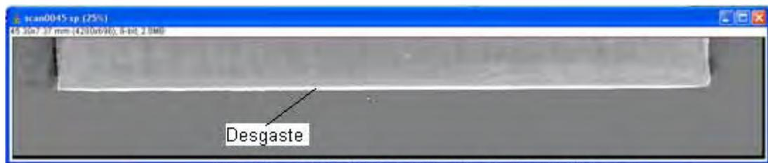
Figura 5.5 - Imagem apresentando a região de desgaste em cor clara mais pronunciada na região central da ferramenta.
