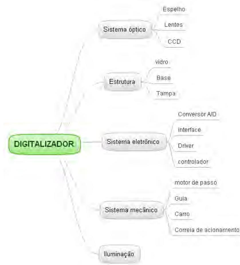
Figura 3.4 - Diagrama esquemático dos componentes de um digitalizador de mesa.
