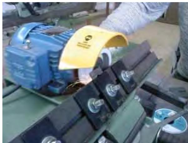
Figura 4.5 - Afição da ferramenta de corte para recuperar a integridade da aresta principal de corte.
