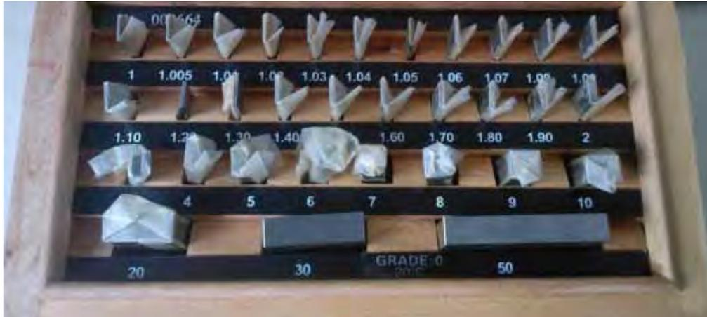
Figura 4.21 – Novo conjunto de blocos padrão utilizados na experimentação.
