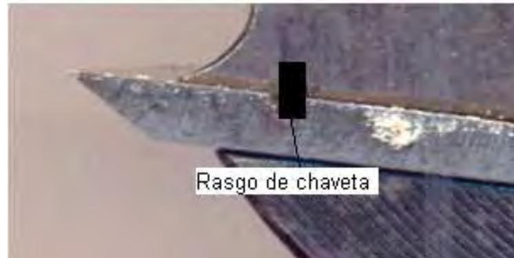
Figura 4.4 - Adaptação para garantir o posicionamento da ferramenta no porta-ferramentas
