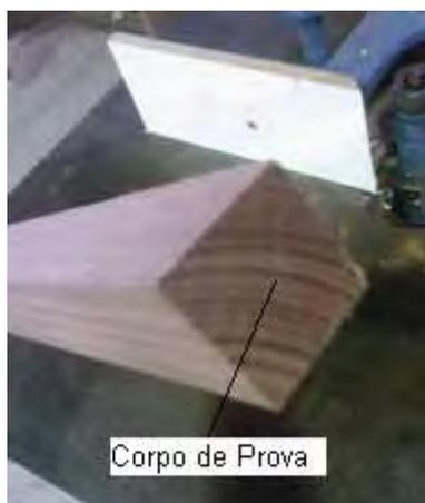
Figura 4.12 – corpo de prova de madeira de *Eucalyptus grandis* utilizada no experimento de usinagem.
