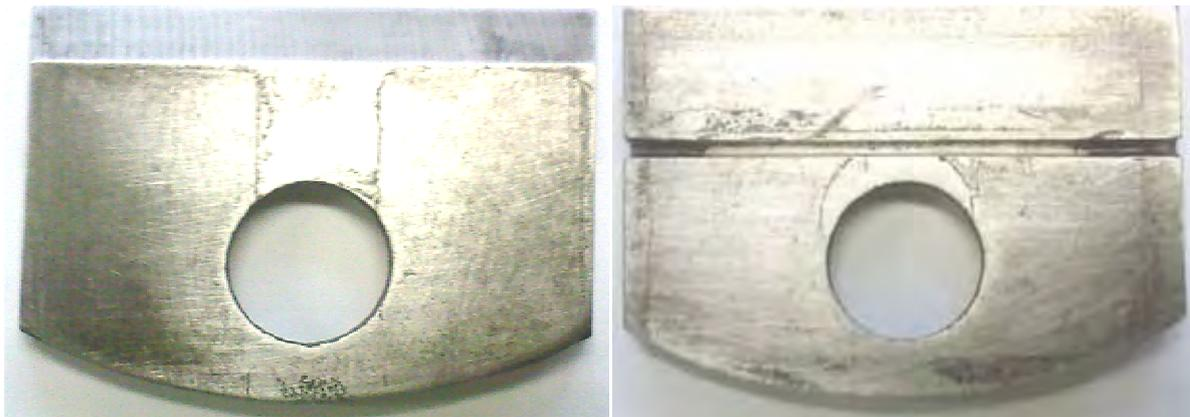
Figura 4.1 - Ferramenta tipo “faca” utilizada na experimentação.
